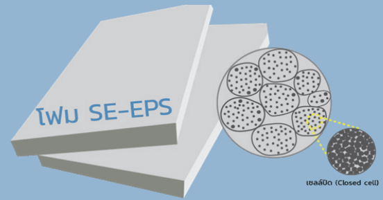
โครงสร้างในแต่ละระดับของโฟม SE-EPS
